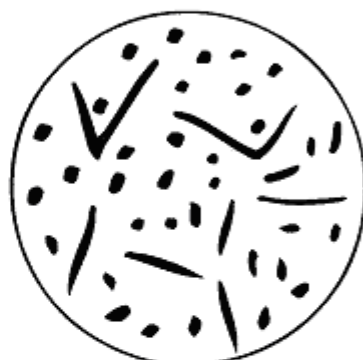
D 型 粒界炭化物の長さ が巾の4~10倍
