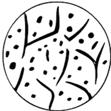
C 型 粒界炭化物の長さ が巾の10倍以上
